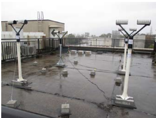
パーシベルによる降灰粒観測準備(鹿大郡元キャンパス) Preparation of Parsivel measurements of volcanic ash particles (kagoshima Univ.)
