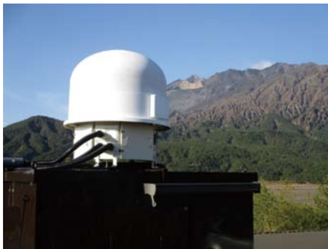
鹿児島大学火山観測用Kuバンド高速スキャンレーダ(桜島) Kagoshima University Ku-band rapid scan radar (Sakurajima)
